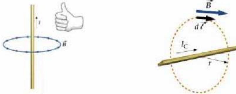
Figura 1.7 Regla de la mano derecha para un conductor rectilíneo, en la determinación de la dirección del campo magnético
